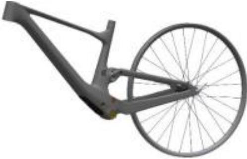
2. Remueva la cubierta de shock del tubo inferior
