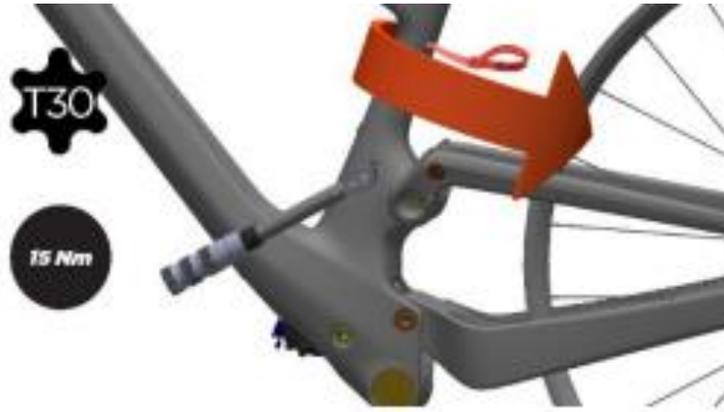
7. Suelte un poco la cinta y ensamble de nuevo el shock con los tornillos del Trunion
