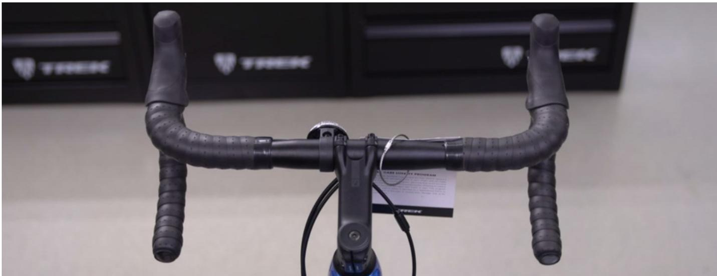
De izquierda a derecha: tapón de manubrio, palanca de freno/mando, reflector, poste de manubrio, etiqueta colgante, palanca de freno/mando, tapón de manubrio.
