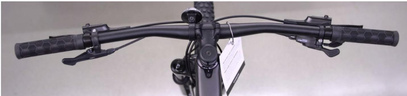
De izquierda a derecha: tapón de manubrio, puño, palanca de freno, poste ajustable o bloqueo, reflector, poste de manubrio, etiqueta colgante, mando, palanca de freno, puño, tapón de manubrio.
