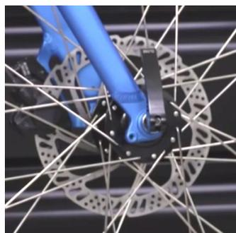
Posición de la palanca de liberación rápida delantera
