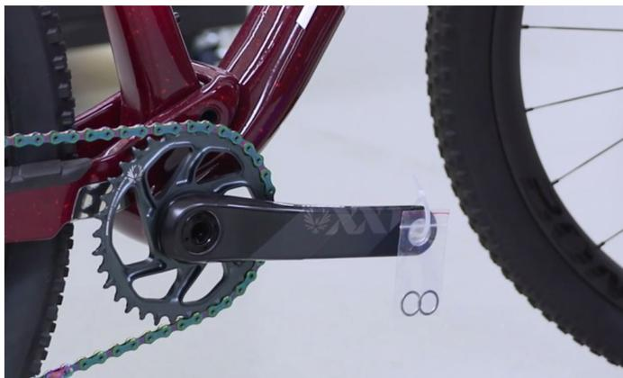
Arandenas de pedal fijadas a la biela
