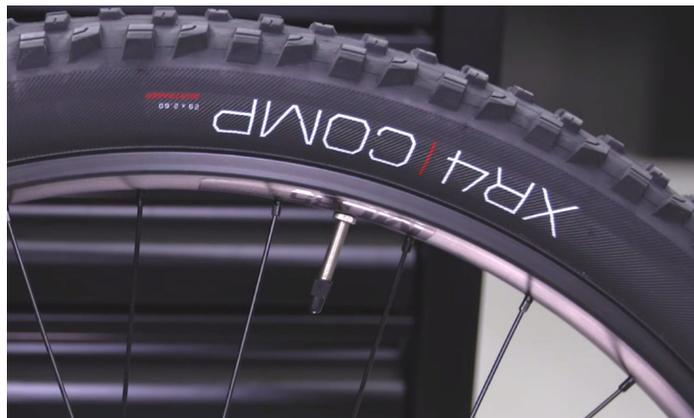
La llanta y el vástago de válvula centrados adecuadamente
