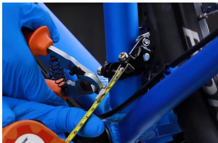
–Asegúrate de que la tapa de extremo del cable esté instalada y firmemente engarzada.
